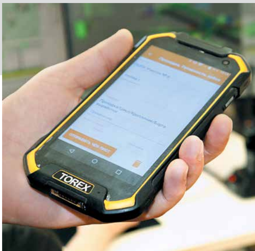
В шахте используют промышленные планшеты — ударопрочные и искробезопасные
